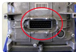
Chybějící záslepky na elektrické zásuvce
