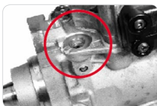
Poškozené závity na tělese čerpadla
