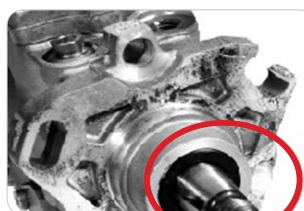
Poškození hncí hřídele a příruby, zbarvení způsobené přehřátím
