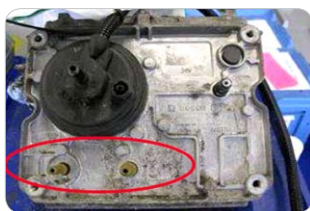
Chybějící záslepky na vývodech
