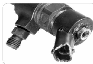
Poškozený konektor vstřikovače
