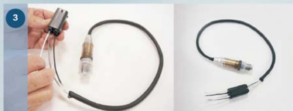
3 Vložte vodiče do konektoru dodávaného s novou univerzální sondou.
