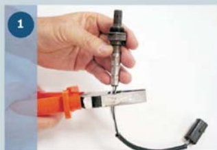
1 Oddělte kabel od demontované sondy.
