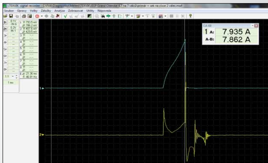
② Záznam měření zapalování ukazuje, že průběh primárního proudu + sekundárního napětí je v pořádku.
