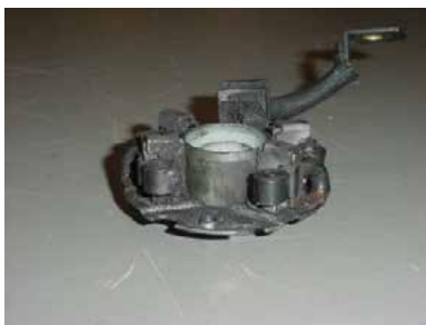
Zaolejovaný vnitřek Velmi opotřebovaný sběrač
