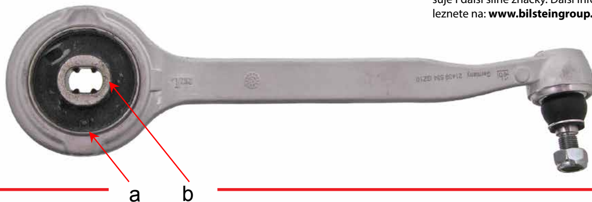
Obr. 3: Montážní poloha hydroložiska
