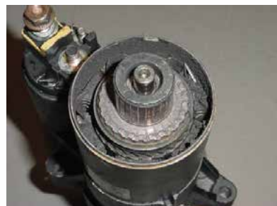
Kotva znečištěná olejem
