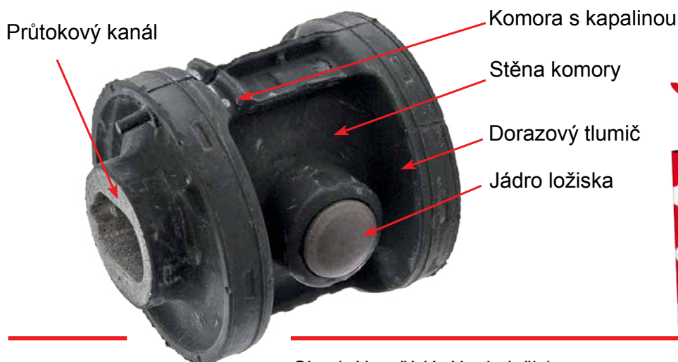
Obr. 1: Uspořádání hydroložiska (bez vnějšího pouzdra)
