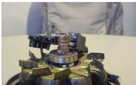
Velmi opotřebované uhlíky Ložisko je plné oleje
