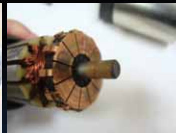
Zoxidovaný spodek turbíny a horní hřídel
