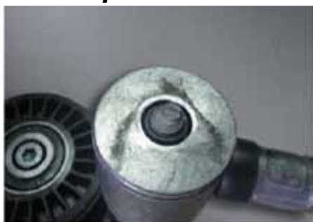
Zlomený upevňovací šroub upínací jednotky
