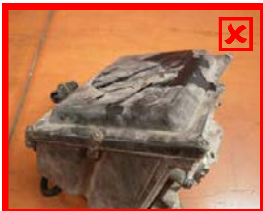
Poškození víka → nevyhovující
