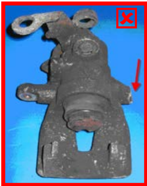
Poškození tělesa/krytu. Částečně ulomeno
